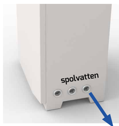
Bild 2 Anslutning av spolvattnets utlopp sker lämpligast med 22 mm. rör eller motsvarande. Om avstånd är längre än 2 m. övergå till plaströr 32 - 40 mm.
