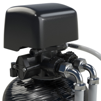
Bild 2 Anslutning av backspolningsvattnets utlopp sker med 1/2" slang, (medföljer) använd slangklamma. Om längre slang än 1,5 m krävs, övergå till spillmuff och därefter 32-40 mm. plaströr. (luftspalt är ett krav).
