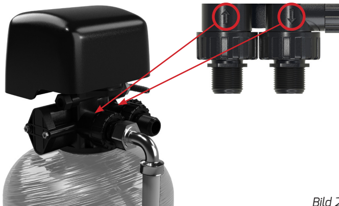
Bild 1 Anslutning av filtret sker lämpligast med flexibla slangar. Automatiken är märkt med pilar in och ut på respektive anslutning, tillse att filtret ansluts rätt.
